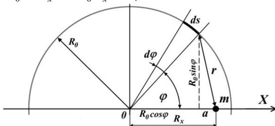
Рис.1.1. Определение силы притяжения тела внутри обруча.
