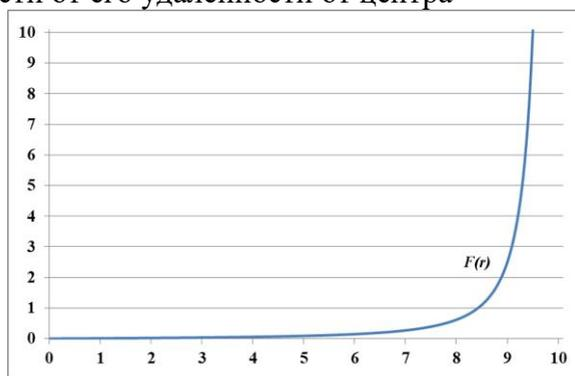
Рис.3.2. График изменения силы притяжения пробного тела, находящегося между двумя массивными точками, в зависимости от его удалённости от центра
