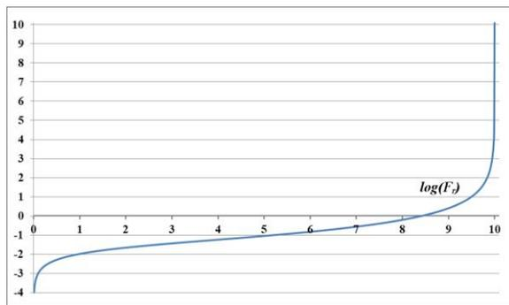
Рис.3.1. Логарифмический график изменения силы притяжения пробного тела, находящегося между двумя массивными точками, в зависимости от его удалённости от центра
